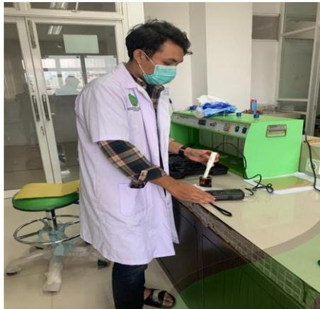
Proses analisis nilai pH menggunakan pH meter di Lab Teknik Lingkungan
