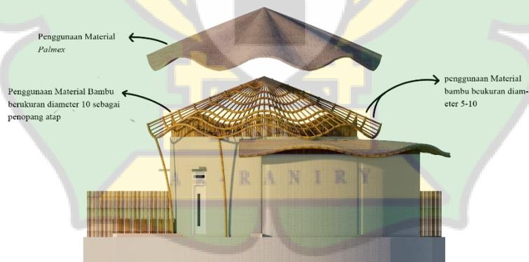
Gambar 4.43 Struktur atap bambu
