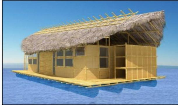
Gambar 2.7 Bangunan Apung dengan Pondasi Bambu
