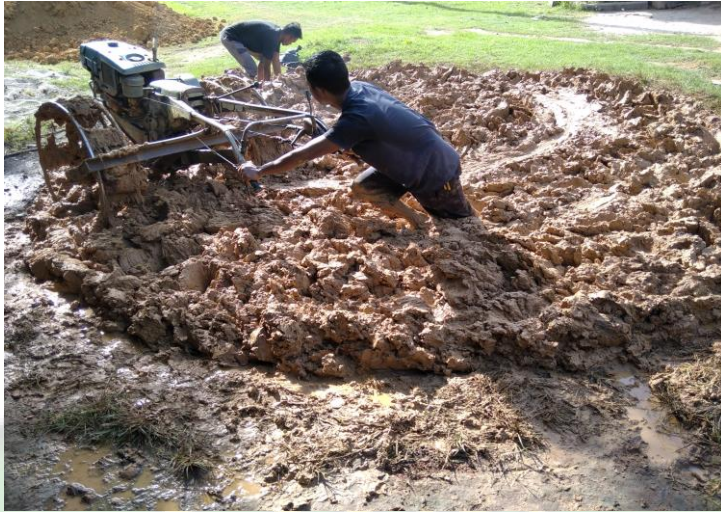
Gambar 1. Proses Pengadukan Material Batu Bata Menggunakan Mesin Kultivator
