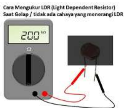
Gambar 11. Cara mengukur LDR saat gelap (Dickson, 2015)
