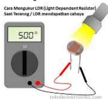
Gambar 10. Cara mengukur LDR saat terang (Dickson, 2015)
