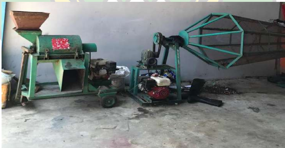
Mesin pencacah sampah plastik TPS-3R Gampong Lambung
