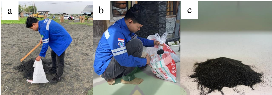
Gambar III.5 (a). Pengambilan pasir besi di Pantai Syiah Kuala. (b). Penggerusan pasir besi (c). Hasil pasir besi yang sudah dipisahkan dari pasir kotor menggunakan magnet permanen.
