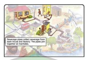
Gambar 5. 33 Contoh 1 Sistem Terpusat Pada Pengolahan Air Kotor
