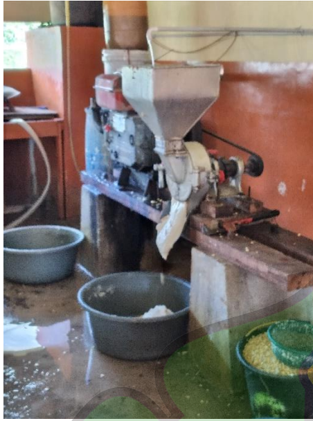
Proses Penggilingan Kacang Kedelai
