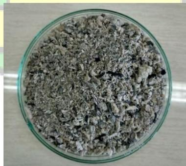
**Gambar 2.2** *Bottom ash* Kelapa Sawit
