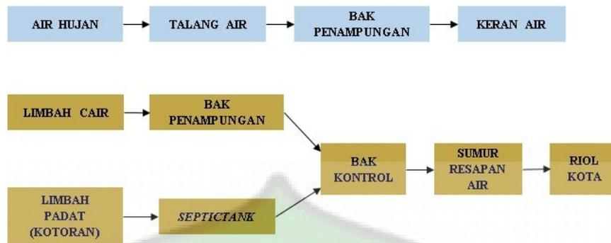
Gambar 5. 13 Skema Instalasi Air Kotor
