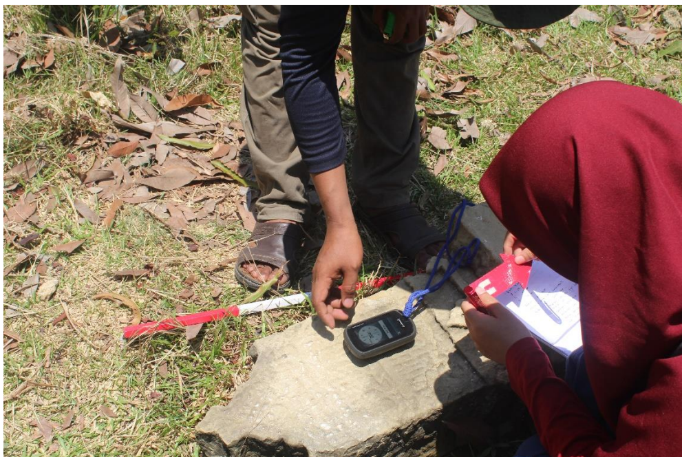
Pengambilan titik koordinat batu nisan menggunakan Global Positioning System (GPS)
