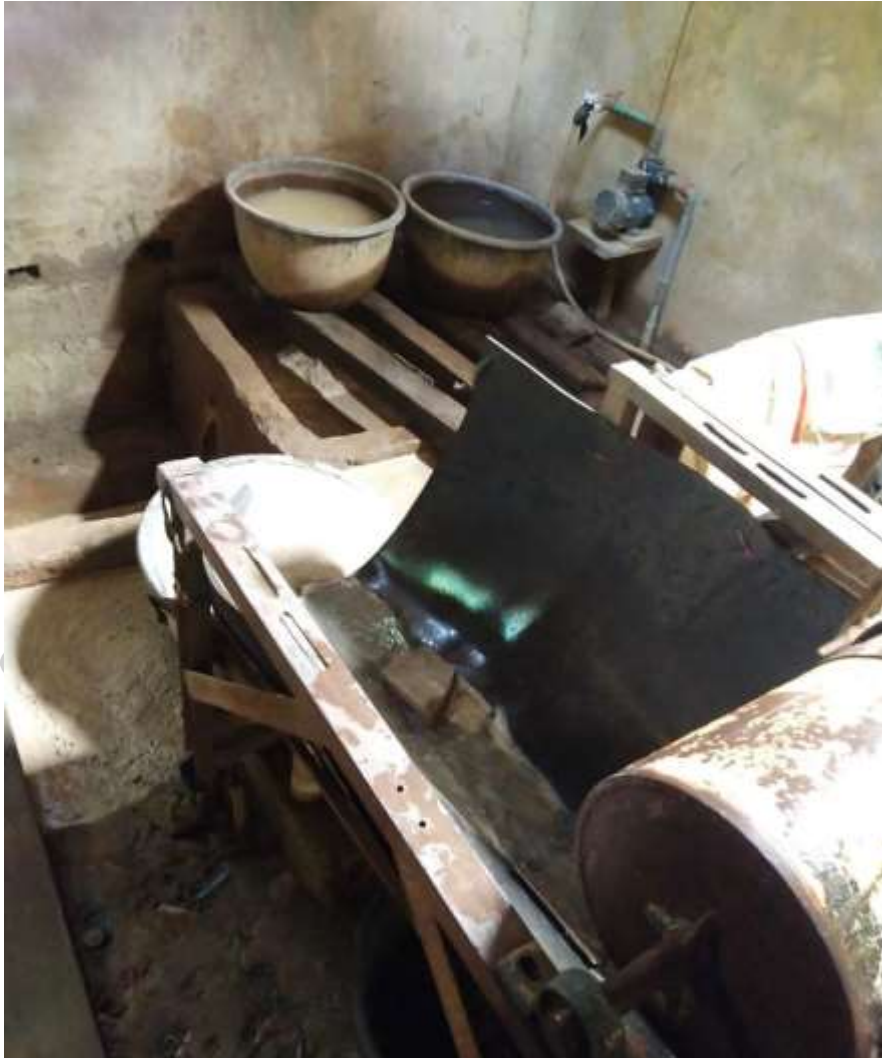
Gambar 2 . Alat yang digunakan untuk menggiling batu emas
