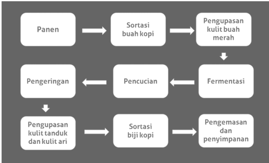
Gambar 2.4 Skema Proses Pengolahan Kopi Secara Basah
