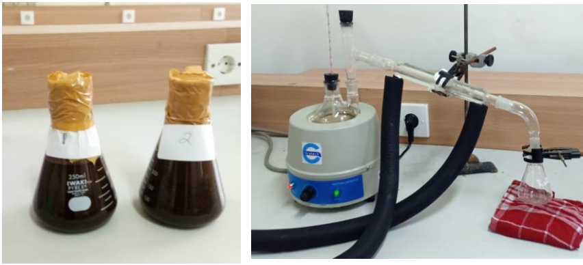
Gambar 4.6 Proses Fermentasi Dan Destilasi Limbah Kulit Kopi Sumber : Dokumentasi Pribadi Tim Peneliti, 2020
