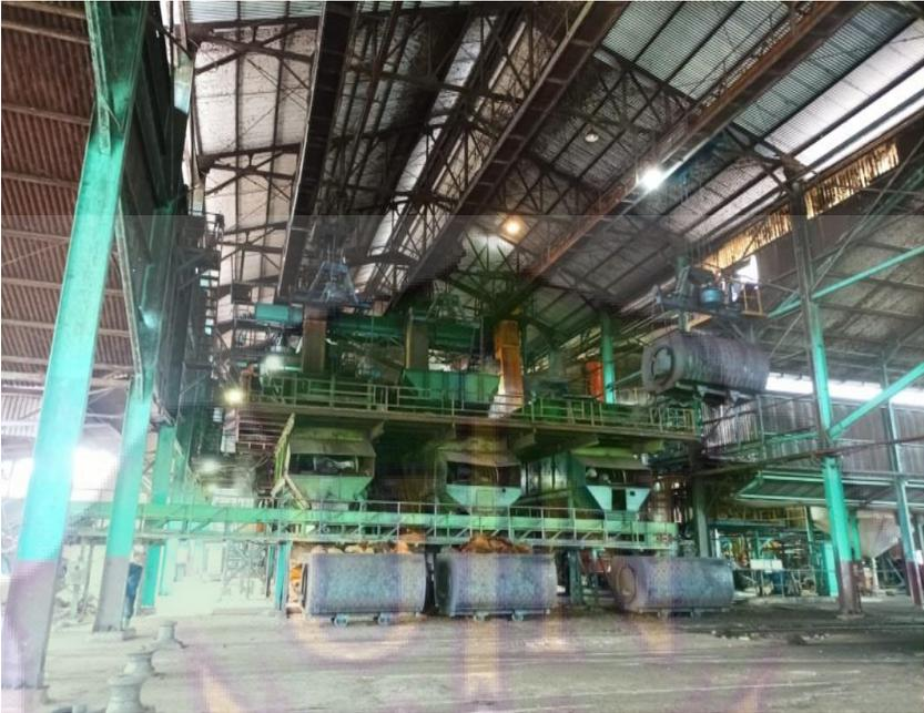
Gambar 2.4. Lori yang berisi Tandan Buah Rebus diangkat menggunakan Hoisting Crane ke Threshing untuk dipipil brondolannya.
