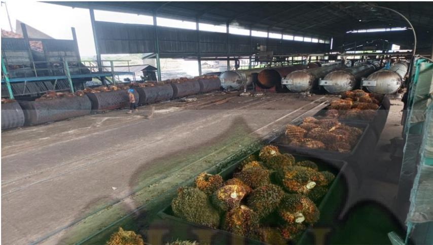
Gambar. 2.3. Tandan Buah Segar diisi ke lori untuk dimasukkan ke rebusan untuk direbus
