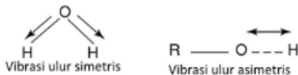
Gambar 2.5 Vibrasi ulur simetris dan asimetris
