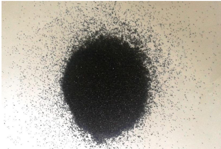
Gambar 4.1. (a) Pasir besi alam, (b) Pasir besi yang telah dipisahkan dari material pengotor dilakukan pengayakan ukuran 200 mesh, (c) Pasir besi hasil ayakan
