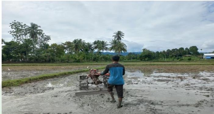
Gambar 1 :Foto Membajak Sawah Dengan Traktor Mini Roda 2
