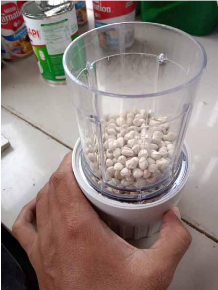
Gambar Proses pembuatan Biokoagulan dari biji kelor
