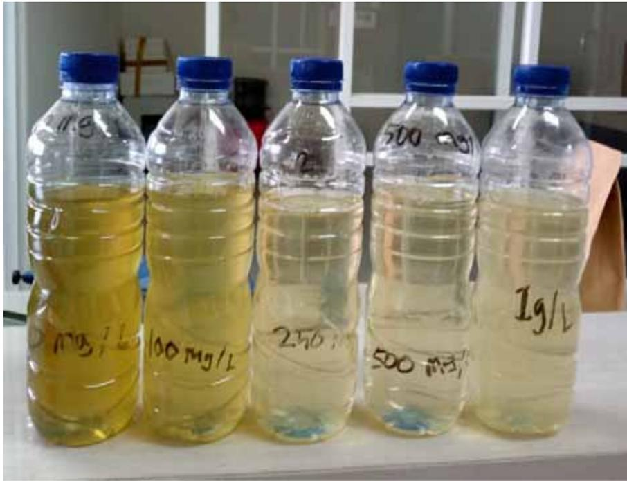
Gambar 4.13 Limbah tahu yang telah dilakukan proses Fitoremediasi koagulasi dan flokulasi
