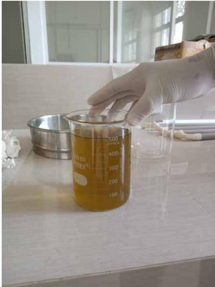
Gambar 4.5 Limbah Tahu setelah pengolahan dengan fitoremediasi
