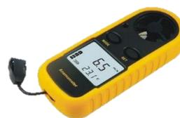
Gambar 3.4 Anemometer
