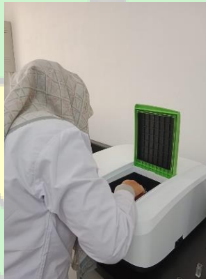
Gambar 8.5 Proses pengukuran nilai absorbansi menggunakan spektrofotometer Uv-Vis untuk data pengukuran SPF
