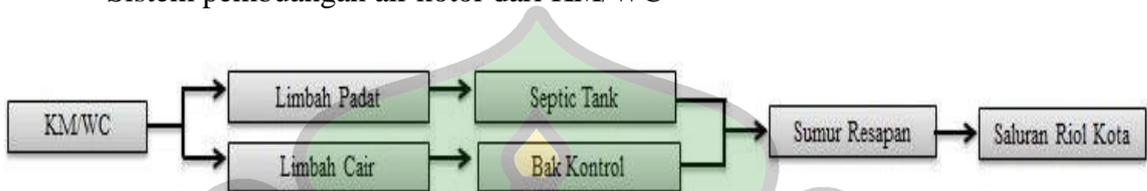
Gambar: 5.9 Skema Pembuangan Air Kotor dari KM/WC
