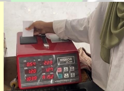
Gambar 8. Proses Pengujian Emisi Gas Buang CO dan NO x
