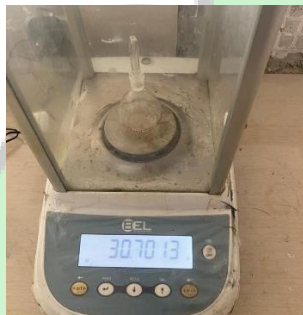
Gambar 4. Proses penimbangan dan pengukuran bobot jenis dengan piknometer kosong, air dan minyak atsiri serai wangi
