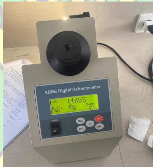
Gambar 1. Proses pengukuran indeks bias minyak atsiri serai wangi menggunakan refractometer ABBE
