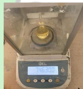
Gambar 4. Proses penimbangan dan pengukuran bobot jenis dengan piknometer kosong, air dan minyak atsiri serai wangi
