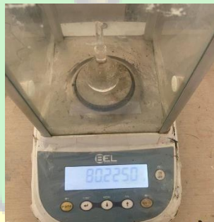
Gambar 4. Proses penimbangan dan pengukuran bobot jenis dengan piknometer kosong, air dan minyak atsiri serai wangi
