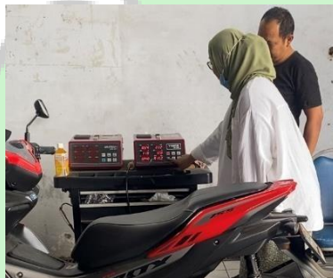
Gambar 8. Proses Pengujian Emisi Gas Buang CO dan NO x
