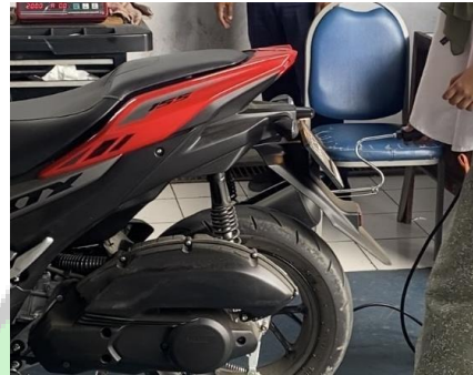
Gambar 7. Dimasukkan selang Probe kedalam knalpot
