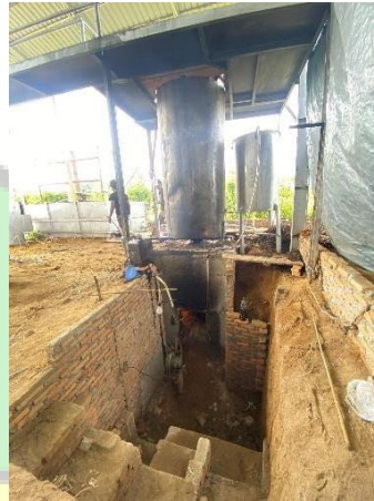
Gambar 2. Proses destilasi minyak atsiri serai wangi menggunakan destilasi air dan uap
