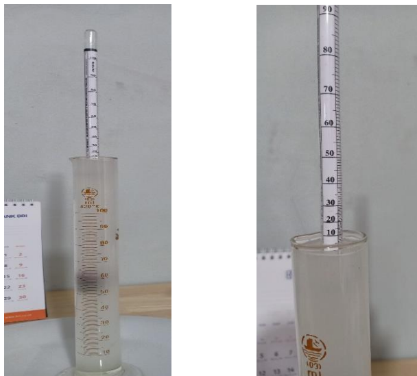
Gambar 4.4 Proses Pengukuran Kadar Alkohol Menggunakan Alkohol Meter
