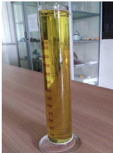
Gambar 3.2 Alat ukur viskositas menggunakan tabung kaca
