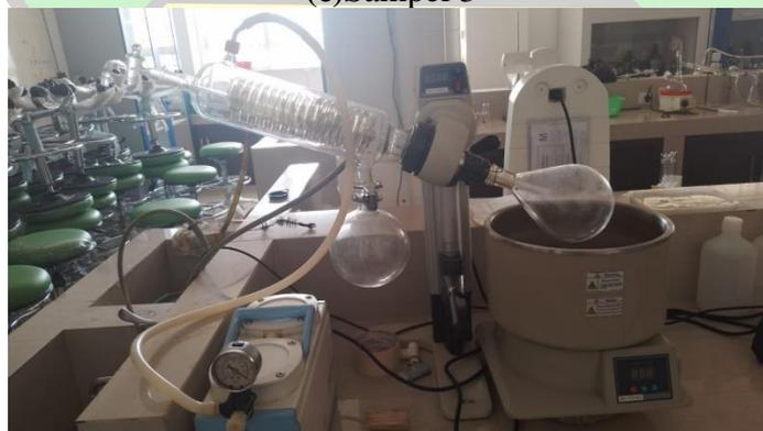
**Gambar 6.** Hasil ekstrak dipekatkan menggunakan *Rotary Evaporator*
