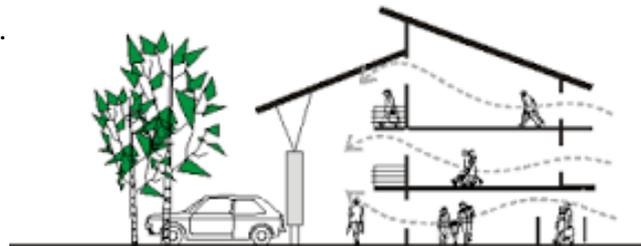
Gambar 3.5 Ilustrasi Ventilasi Silang
