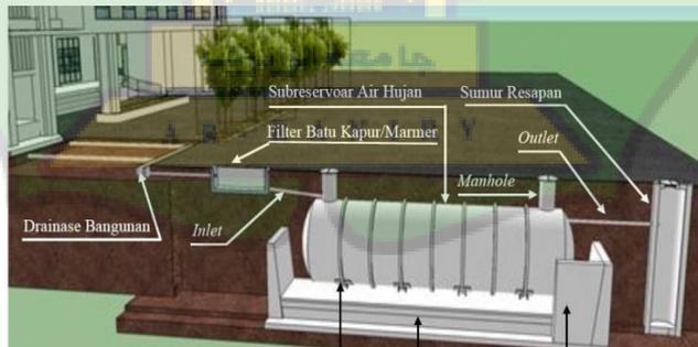
Gambar 5.5 Ilustrasi Sistem Pemanfaatan Air Hujan (SPA)
