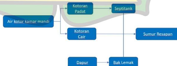
Gambar 4.50 : Skematik jaringan Air Kotor
