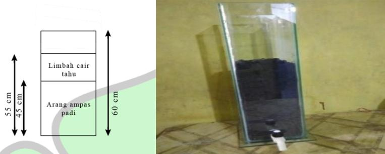
Gambar 3.6 Kolom Filtrasi Dengan Isi Bahan Arang Ampas Padi
