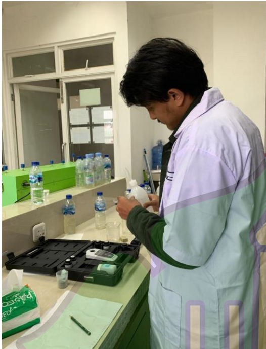
Proses Penuangan Sampel Kedalam Botol Lutron Turbidimeter untuk dilakukan pengukuran
