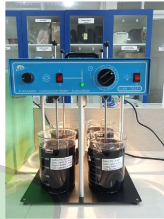
Pengadukan Sampel Adsorben Karbon Aktif Asam Jawa 10 Gram 15 Menit, 10 Gram 30 Menit, 10 Gram 45 Menit, 10 Gram 60 Menit Sesuai Waktu Kontak Menggunakan Jarrest.
