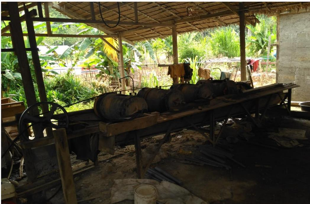
Gambar Mesin Gelondong Tempang pengilingan batu emas di Gampong Simpang Tiga
