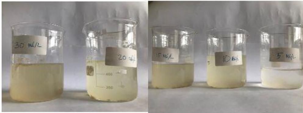
Gambar 4.4 Proses Pengendapan Larutan Koagulan Biji Nangka
