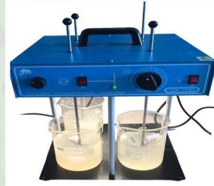
Gambar 4.3 (a) Proses Pengadukan Cepat Larutan Serbuk Biji Nangka (b) Proses Pengadukan Lambat Larutan Serbuk Biji Nangka
