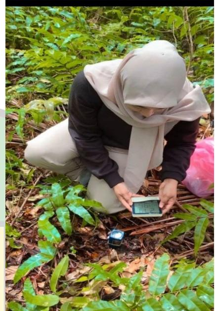
Pengukuran kelembaban udara Menggunakan hygrometer
