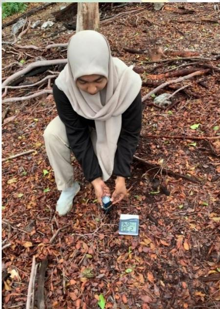
Pengukuran kelembaban dan pH tanah menggunakan soil stester
