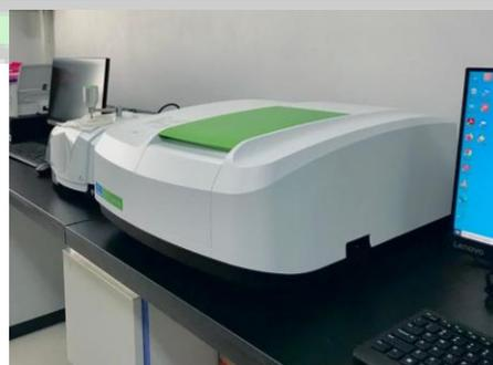
**Gambar II.5** Spektrofotometer UV-Vis
