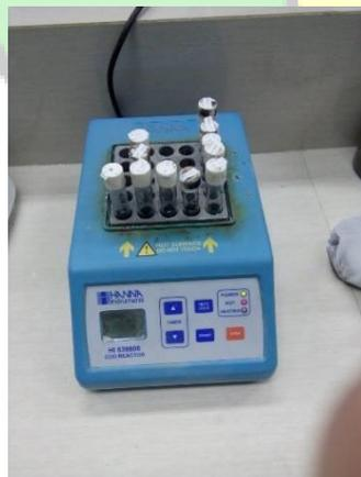
Proses pemanasan sampel menggunakan COD reactor selama 2 jam
