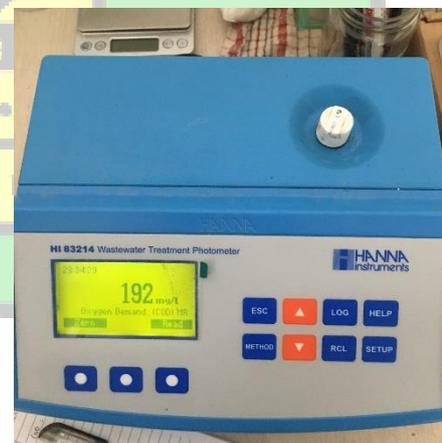
Proses pengukuran COD sampel limbah cair RPH menggunakan *COD meter*
