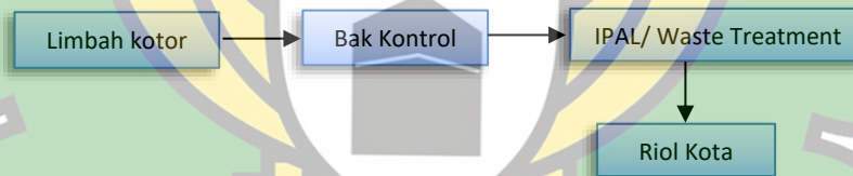
Skema 6.2 Sistem Sanitasi Air Kotor
