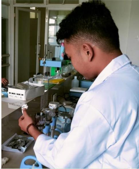
Penyaringan sampel mikroplastik menggunakan vakum filtrasi.
