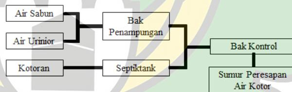
Gambar 4.34 Sistem pengaliran air kotor
