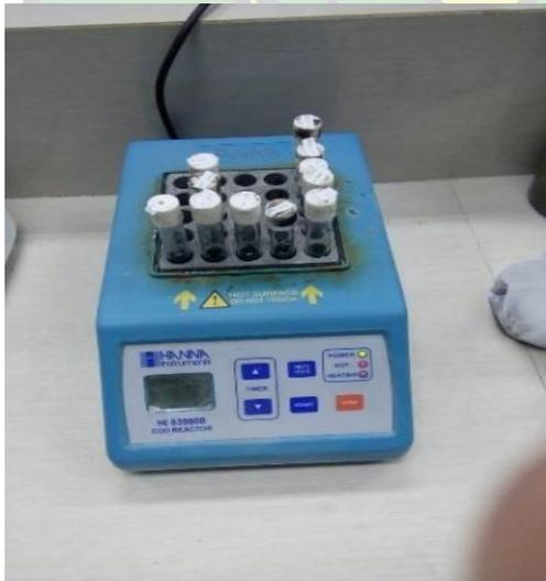
Proses Pemanasan Sampel Menggunakan COD Reactor Selama 2 Jam
