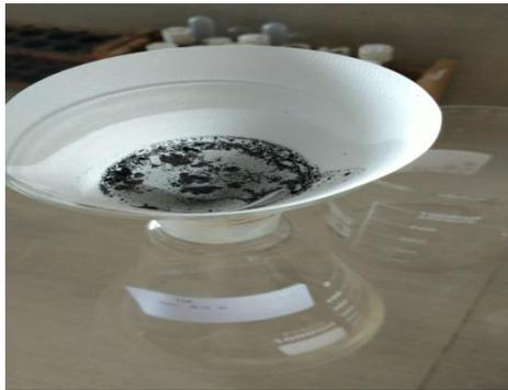
Proses penyaringan filtrat untuk pengujian
