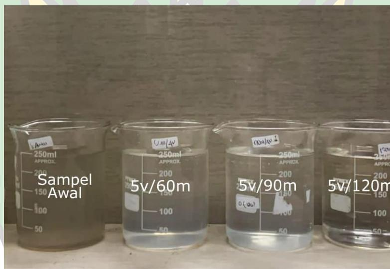
**Gambar 4.3** Penampakan Fisik Air Limbah Awal Air Limbah Penatu Sebelum Dan Setelah Proses Elektrokoagulasi Variasi Tegangan 5V Dengan Waktu Kontak 60,90 Dan 120 Menit.
