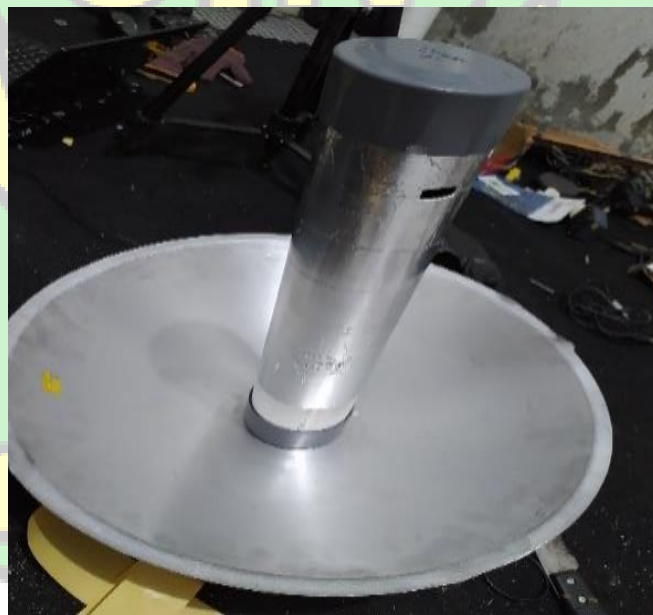
Gambar 3. 7 Bentuk pipa Wajan bolic yang sudah dilapsi semua Alumunium foil
