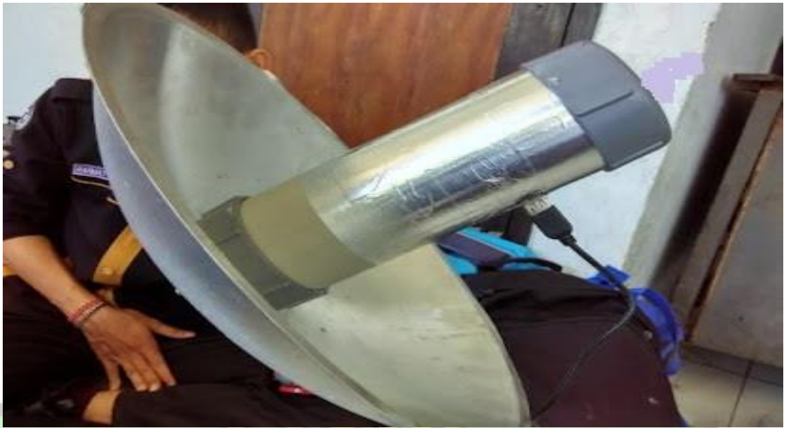
Lampiran 1.1 Perangkat Jaringan Antena Wajan Bolic siap di gunakan
