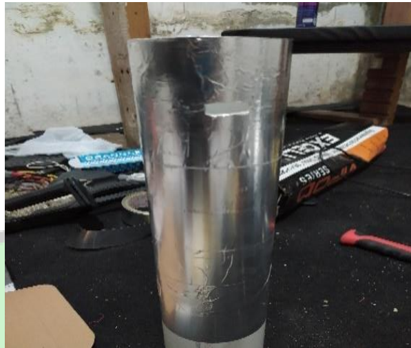
Gambar 3. 6 Lapsian Alumunium foil pada pipa
