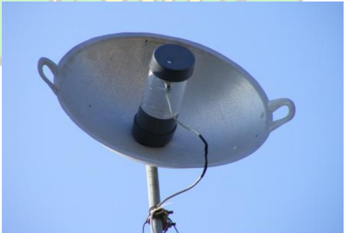
Lampiran 1.1 Perangkat Jaringan Antena Wajan Bolic siap di gunakan
