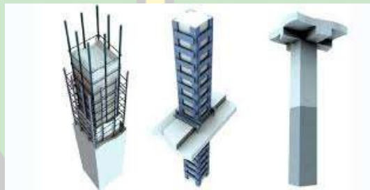
Gambar 5.15 Kolom Beton Bertulang Sumber: http://Builder.id , 2020
