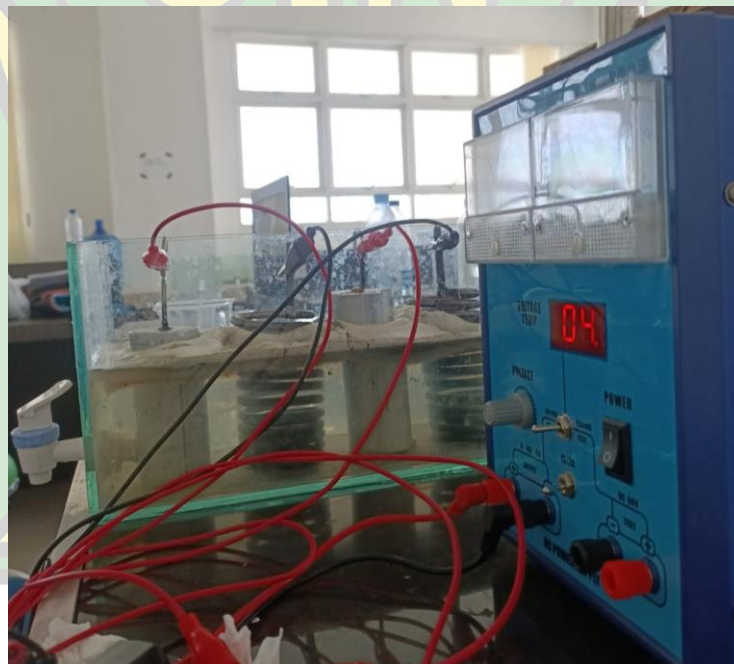
Gambar 4. 4 Proses Elektrokoagulasi Menggunakan Elektroda Aluminium Silinder Dan Besi Spiral
