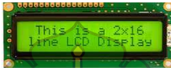
Gambar 2. 7Bentuk Fisik LCD 16 x 2
