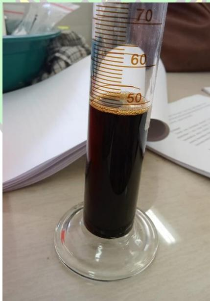
Gambar Ekstrak kental setelah diuapkan menggunakan *rotary vaccum evaporator*
