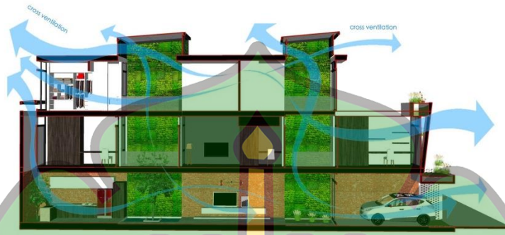
Gambar 3.3 Ventilasi Silang Sumber : Dekoruma, 2021
