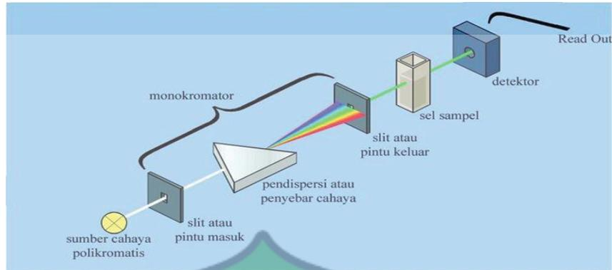
Gambar II.2 Diagram Alat Spektrofotometri UV-Vis (Dewi, 2018)
