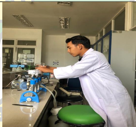
Penyaringan sampel mikroplastik menggunakan vakum filtrasi
