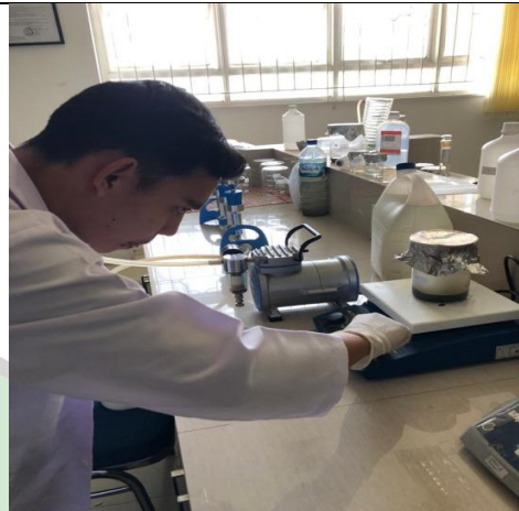
Lalu homogenkan sampel menggunakan magnetic stirrer dan diamkan sampel selama 24 jam
