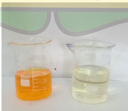
Gambar 4.13 (Kiri)Metil Orange 25 Ppm (Kanan) Filtrat Hasil Adsorpsi Karbon Aktif Dengan Waktu Kontak 60 Menit
