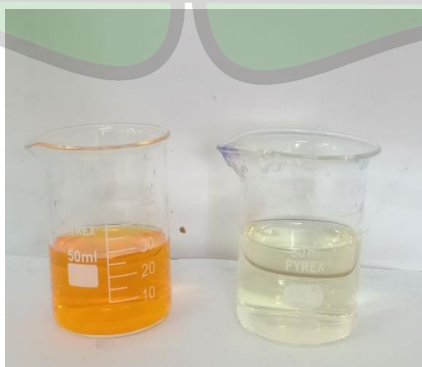
Gambar 4.9 (Kiri) Filtrat Hasil Adsorpsi Karbon Aktif Dengan Dosis 0,3 (Kanan) Metil Orange 10 Ppm
