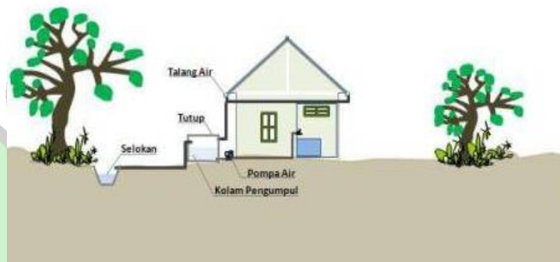
Gambar 4.59 Talang Pipa Air Penampung Hujan (sumber :bebasbanjir2025)
